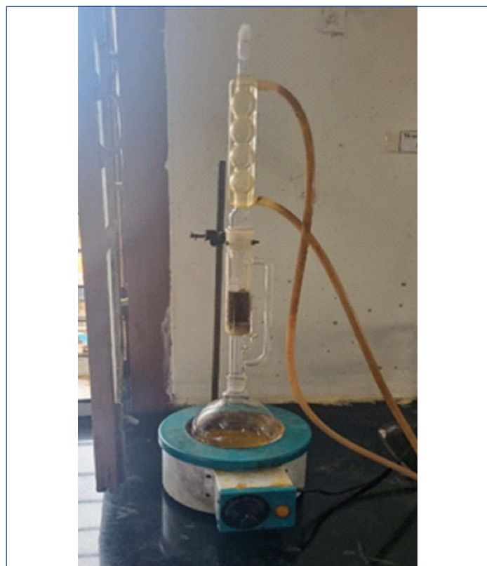
[Table/Fig-2]: Soxhlet apparatus [11].
